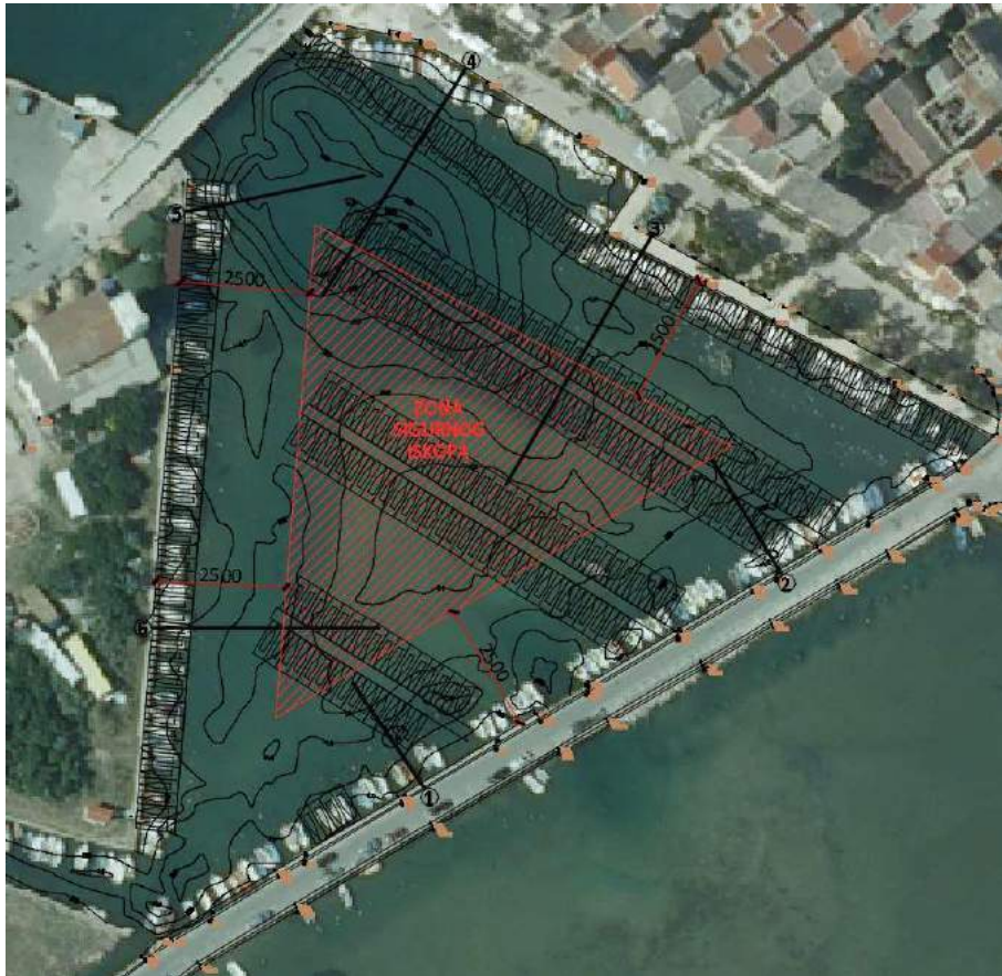
Slika 3.1.-2.: Shematski prikaz položaja poprečnih profila (pokosa) i zona sigurnog iskopa
